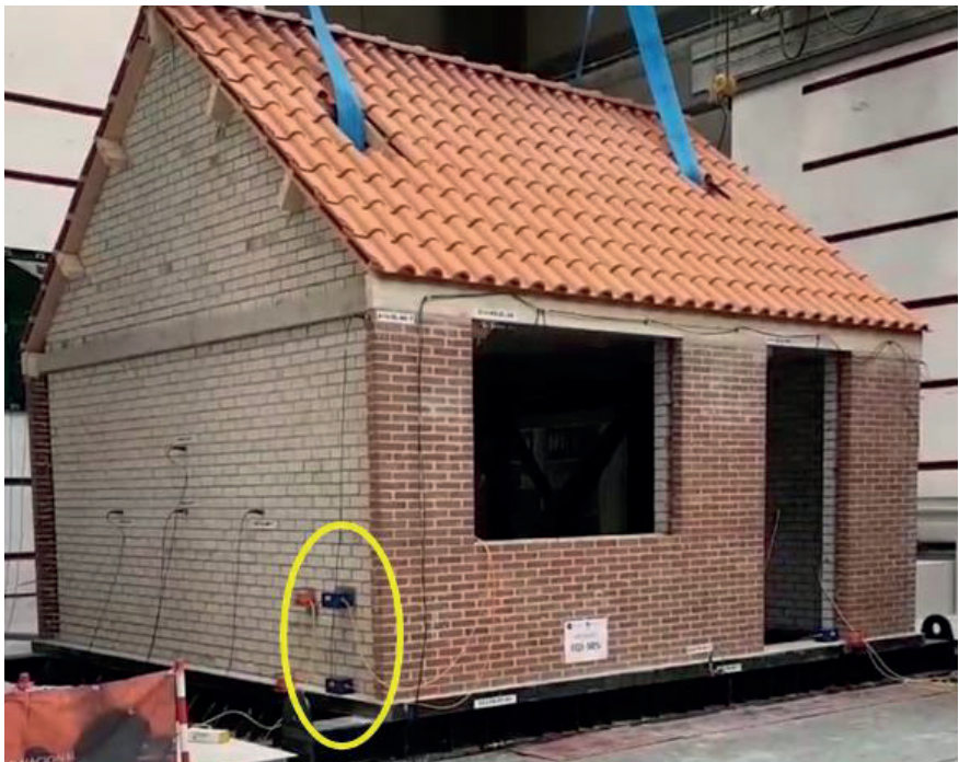
Figuur 6. Reproductie van versnellingsmeters op de begane grond en op een hoger niveau in een triltafelmodel in LNEC, Portugal (uit: Bommer et al., 2018)
